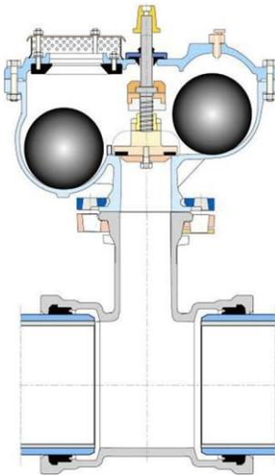
Montaje directo sobre una te: el sistema de cierre central permite, sin cortar el agua, realizar un mantenimiento regular de la Ventex, en particular cambiando el flotador del lado de la tobera
