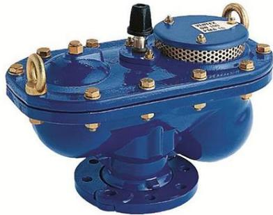
Las ventosas protegen las canalizaciones contra las depresiones durante el vaciado (mediante la capacidad de admisión de un gran caudal de aire) y durante el llenado (con la capacidad de evacuación de gran caudal de aire).
