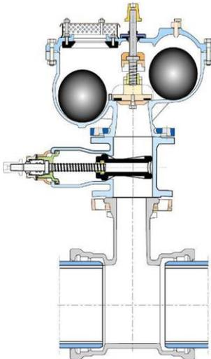
Montaje con válvula de corte: para la reparación del sistema de maniobra o de la junta de la clapeta, insertar una válvula de corte
