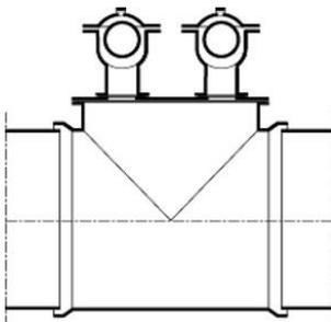
Montaje con dos ventosas DN200: para tubos de DN1400 a 1800: según el croquis, utilizando una té con derivación igual al DN de la canalización y una placa especial
